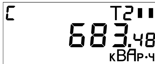
Рисунок Е.8 - Пример индикации текущих показаний реактивной энергии (емкостной) (текущий тариф по активной энергии – 2)
