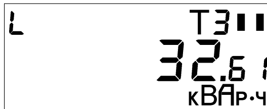
Рисунок 13 - Пример индикации текущих показаний реактивной энергии (индуктивной) (текущий тариф по активной энергии – 3)
