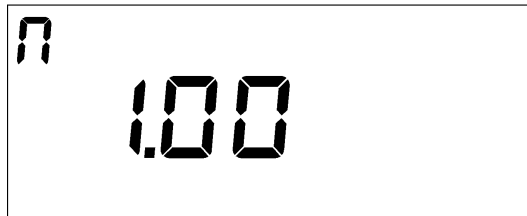
Рисунок 8 - Пример индикации версии ПО счетчика
