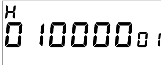
Рисунок 6 - Пример индикации заводского номера счетчика (в примере 1000001)
