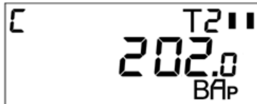
Рисунок 19- Пример индикации текущей реактивной мощности (текущий тариф по активной энергии– 2)
