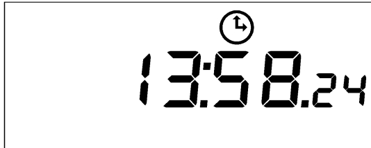
Рисунок 25 - Пример индикации текущего времени счетчика
