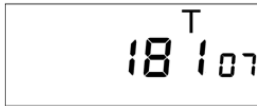
Рисунок 7 - Пример индикации типа счетчика
