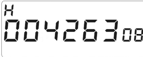
Рисунок Е.3 - Пример индикации заводского номера счетчика
