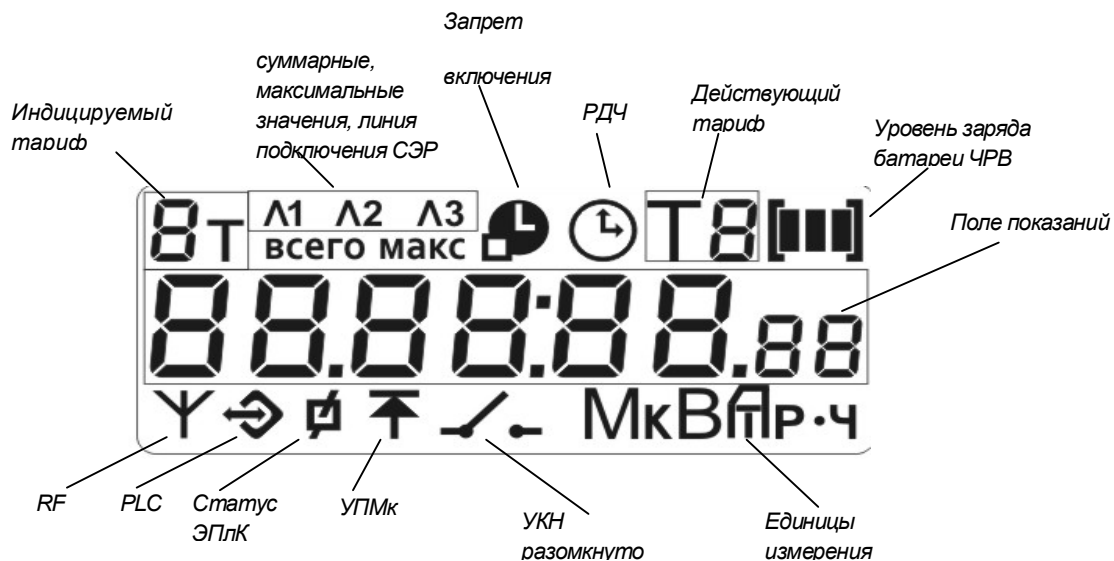
Рисунок Е.1 – Расположение полей дисплея счетчика
