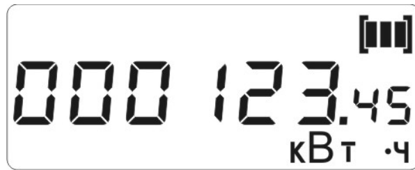
Рисунок Е.6 - Пример индикации суммарных показаний активной энергии с ведущими нулями
