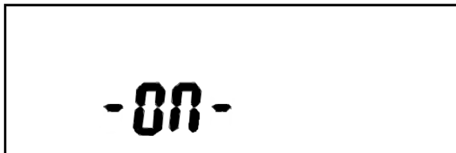
Рисунок 24 - Пример индикации готовности к работе оптопорта
