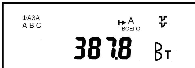
Рисунок 12 - Пример индикации значения суммарной активной мощности
