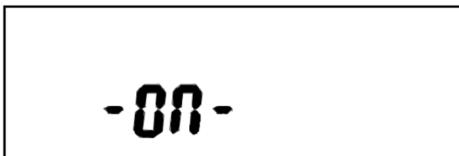
Рисунок 24 - Пример индикации готовности к работе оптопорта
