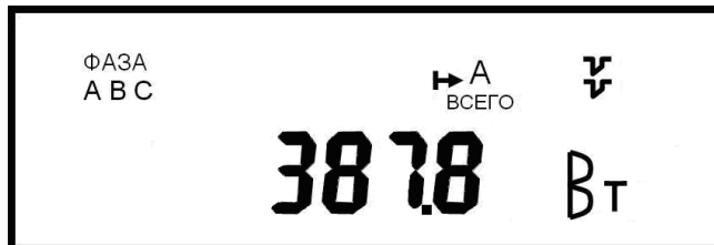
Рисунок 12 - Пример индикации значения суммарной активной мощности
