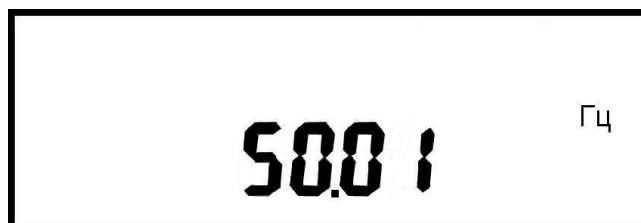
Рисунок 15 - Пример индикации значения частоты сети
