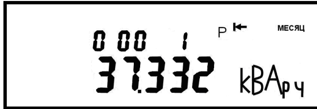
Рисунок 9 - Пример индикации значения емкостной (отрицательной) реактивной энергии на РДЧ. В поле «Дата/Время» индицируется РДЧ
