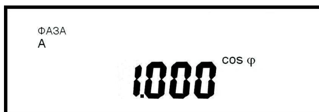
Рисунок 16 - Пример индикации значения коэффициента мощности по фазе А
