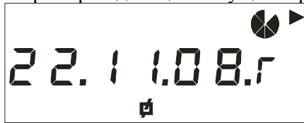
Рисунок 9 – Пример индикации текущей даты ЧРВ счетчика
