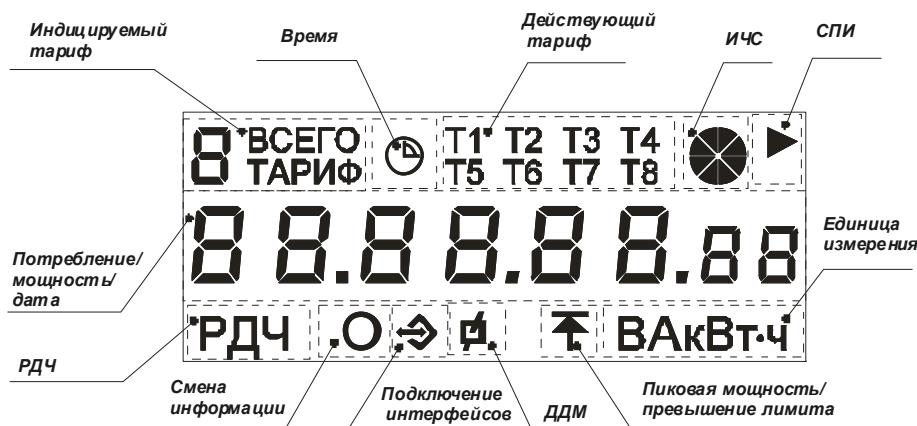
Рисунок Ж.1 – Расположение полей дисплея счетчика
