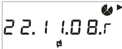
Рисунок Ж.6 – Пример индикации текущей даты ЧРВ счетчика
