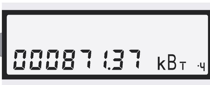
Рисунок Д.4 – Вид дисплея при выводе суммарных текущих показаний счетчика с ведущими нулями
