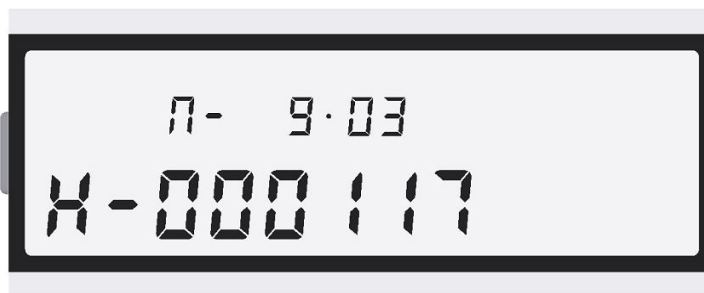
Рисунок Д.3 – Вид дисплея при выводе версии ПО и заводского номера счетчика На рисунке показано: Н-000117 – заводской номер счетчика, П - 9.03 – номер версии (идентификационный номер) ПО
