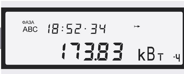
Рисунок Д.6 – Пример вывода показаний в однотарифном режиме
