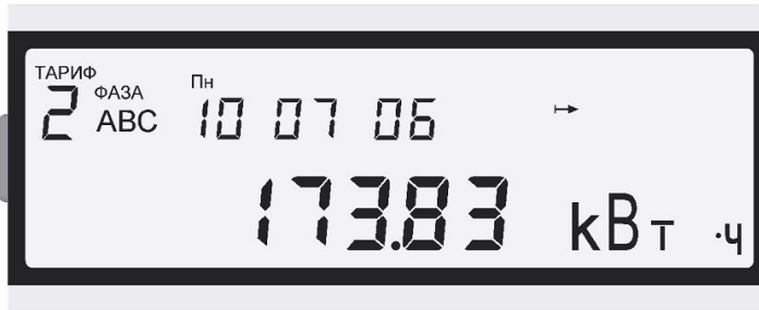
Рисунок Д.5 – Пример вывода показаний по 2 тарифу
